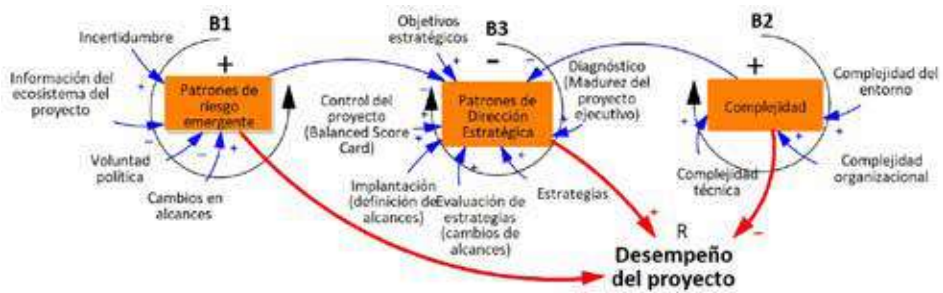
Figura 23. Modelo DURICA para medir el desempeño y la complejidad de un proyecto de construcción
